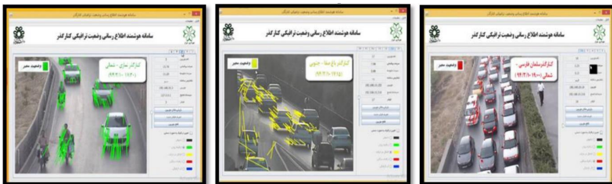
Obrázok 3 Meraniepriemernejrýchlostipremávky kamerovým systémom. Zdroj: Sodagaran 2016
